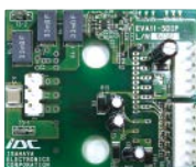
Super mini DIIPM™ evaluation board EVA11-SDIP
